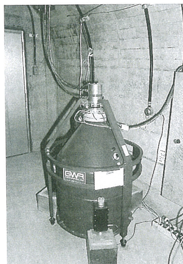
地下30mの観測坑道に設置された超伝導重力計 Superconducting gravimeter installed at the bottom of the observation tunnel
