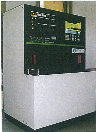
蛍光 X 線分析装置 X-ray Fluorescence Spectrometer(3030)
