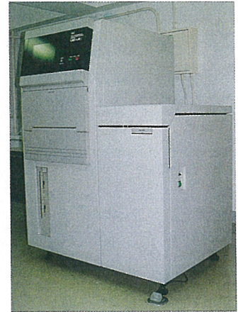
液体シンチレーションシステム Liquid Scintillation System(LSC-LBIII)
